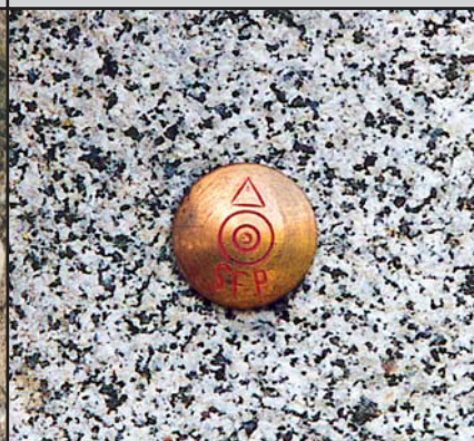
SFP Messingbolzen Ø 3 cm
