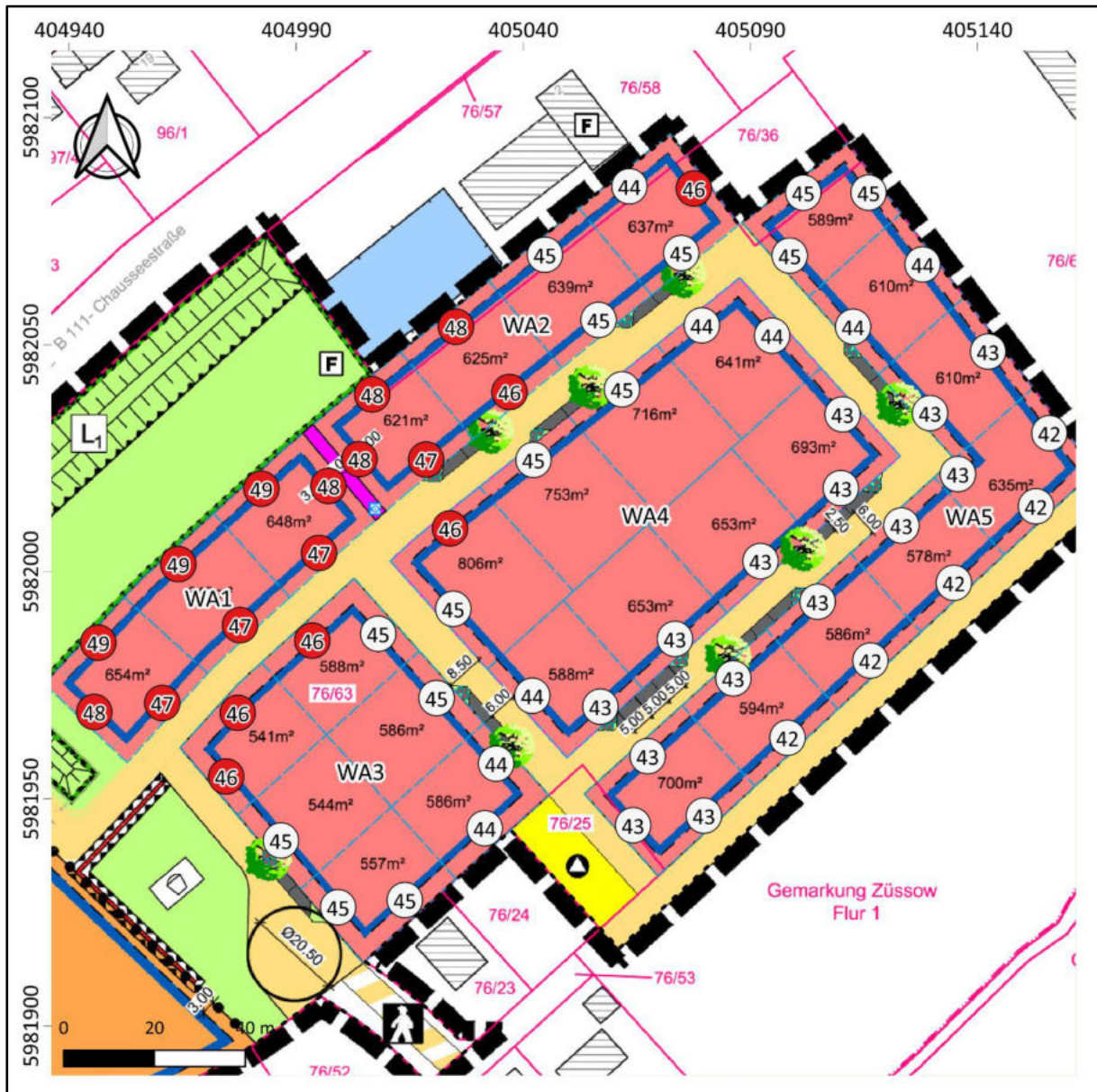
Abbildung 9: Immissionsraster Verkehrslärm, Beurteilungszeit Nacht, Überschreitungen rot gekennzeichnet, DG (Höhe 5 m)
