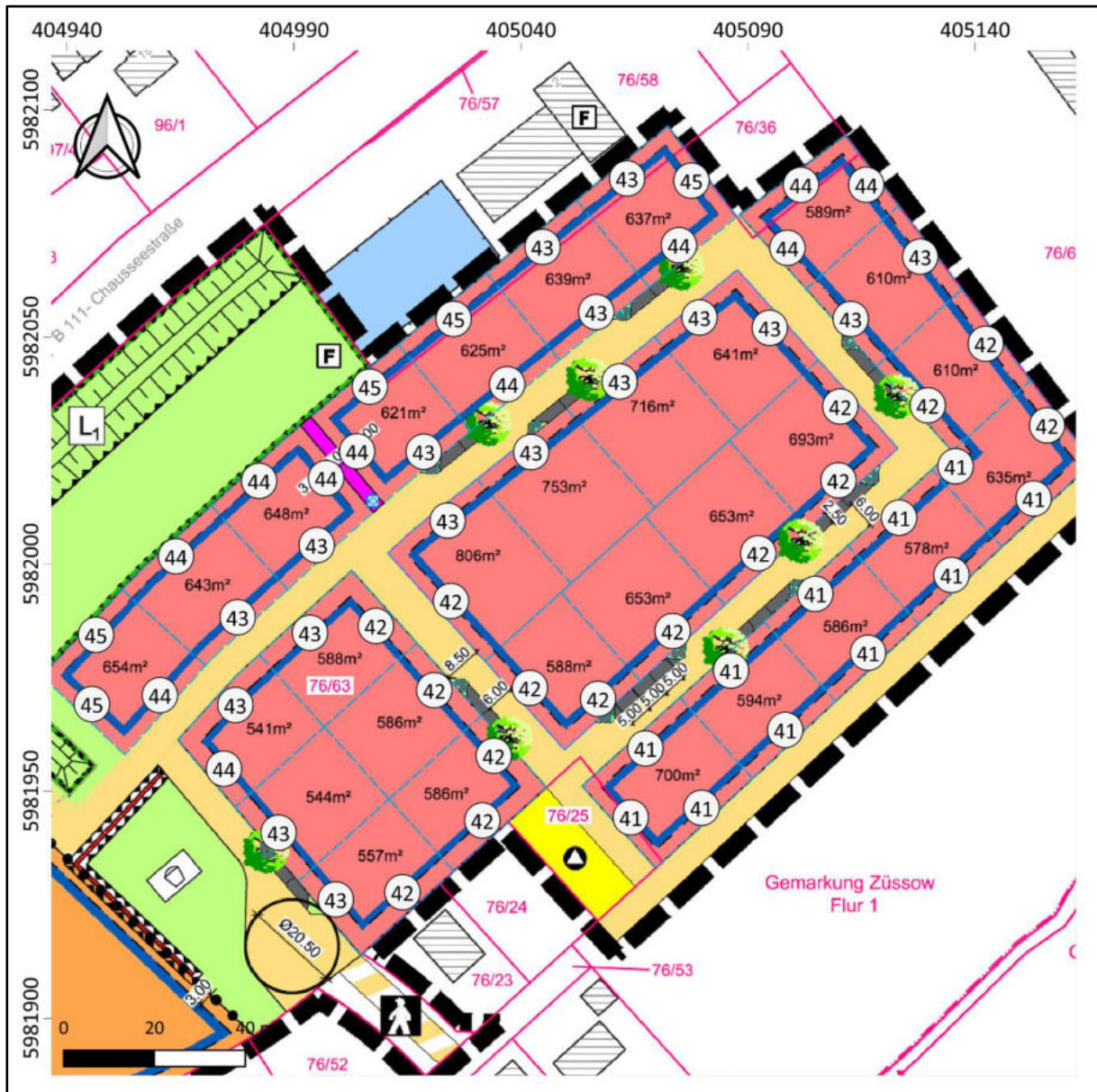
Abbildung 13: Immissionsraster Verkehrslärm mit Lärmschutzwall, Überschreitungen rot gekennzeichnet, Beurteilungszeit Nacht, DG (Höhe 5 m)
